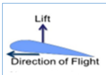
شکل ۱: نیروی بالابرنده و تاثیر آن در حرکت پره ها
